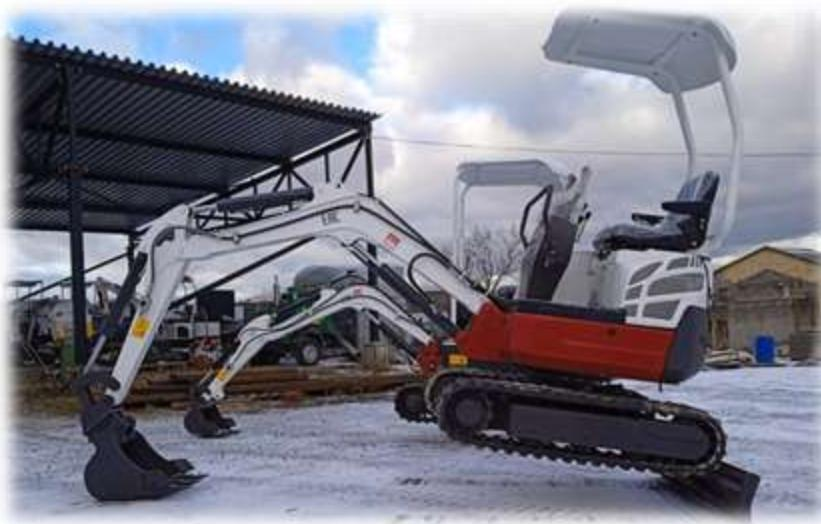
Мини-экскаватор QUADTRAC E20PRO – самый мощный и тяжелый в линейке QUADTRAC . Отличительной особенностью данной модели является : управление электро-гидравлическими джойстиками в подлокотниках , поворот стрелы на 120 град , мощный аксиально-поршневой гидравлический насос .
