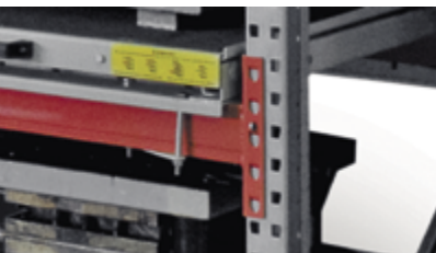
Крепление балки к стойке
