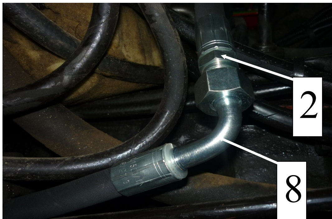
Рис. 3. Место подключения шланга возврата питания к трактору. (вид с левой стороны трактора, под полом и педалью тормоза)
