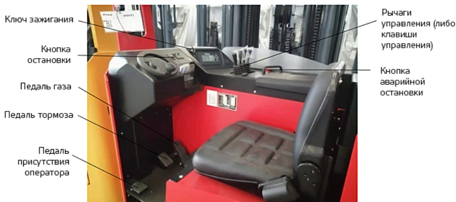
Рисунок 10. Основные устройства управления в кабине оператора
