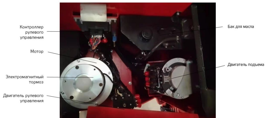
Рисунок 5. Расположение основных деталей
