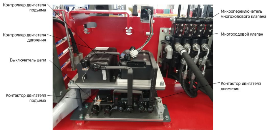
Рисунок 6. Расположение деталей
