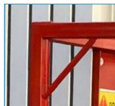
Скоба для зацепа страховочного троса безопасности
