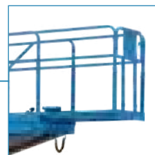
Выдвижная платформа (длина - 0.8 м, грузоподъемность - 100 кг)
