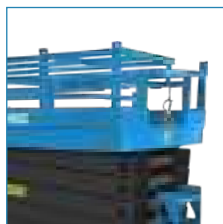
Складывающиеся поручни для удобства эксплуатации
