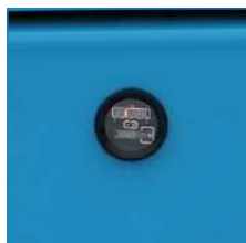
Встроенный счетчик для отслеживания количества отработанных моточасов
