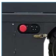
Кнопка аварийного выключения
