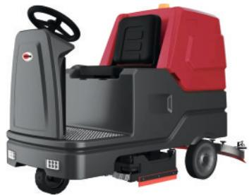
Поломоечная машина с сиденьем для оператора оснащена тяговым приводом на переднее колесо, двумя дисковыми щётками с общей рабочей шириной 850 мм. Оптимальное сочетание размеров поломоечной машины и ёмкости АКБ позволяет максимально эффективно использовать её при работе. Производительность от 5300 м<sup>2</sup>/ч, дают возможность оператору убирать более 10 000 м<sup>2</sup> за смену. Подходит для глубокой и поддерживающей уборки больших площадей.
