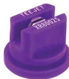
Форсунка Teejet XR80025 Расход – 0,57-1,14 л/мин., в зависимости от давления
