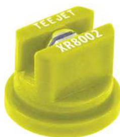
Форсунка Teejet XR8002 Расход – 0,46-0,91 л/мин., в зависимости от давления
