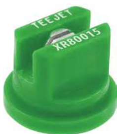
Форсунка Teejet XR80015 Расход – 0,34-0,68 л/мин., в зависимости от давления
