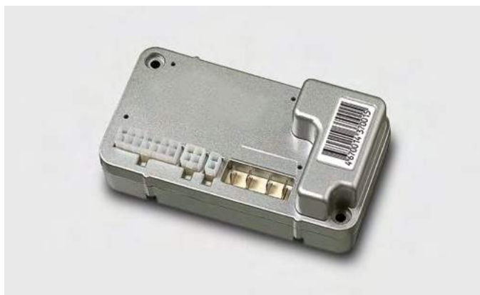
Микропроцессорный контроллер , с его помощью осуществляется управление скоростью и движением, также он позволяет плавно трогаться и тормозить, причем при торможении происходит рекуперация энергии, и аккумуляторы заряжаются. Контроллер и вся электроника помещены в герметичный отсек с классом защиты IP-67.
