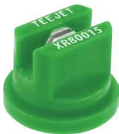
Форсунка Teejet XR80015 Расход – 0,34-0,68 л/мин., в зависимости от давления
