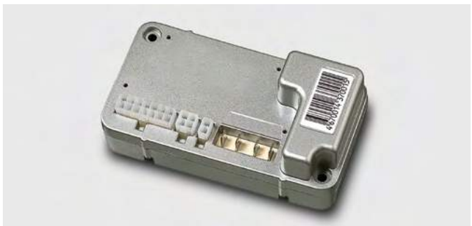
Отдельного внимания заслуживает установленный микропроцессорный контроллер , с его помощью осуществляется управление скоростью и движением, также он позволяет плавно трогаться и тормозить, причем при торможении происходит рекуперация энергии, и аккумуляторы заряжаются. Контроллер и вся электроника помещены в герметичный отсек с классом защиты IP-67.
