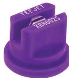
Форсунка Teejet XR80025 Расход – 0,57-1,14 л/мин., в зависимости от давления
