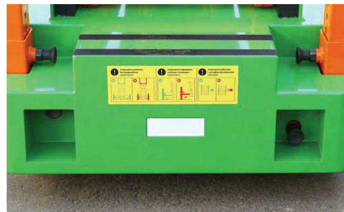
Для безопасного и комфортного доступа на платформу шасси тележки оснащено противоскользящей лентой .
