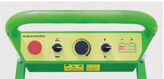
Пульт управления. Удобный и эргономичный, с плавной регулировкой скорости и переключателем вперед-назад. Пульт имеет привлекательный вид, оборудован аварийной кнопкой остановки, переключателем подъема и опускания платформы и индикатором уровня заряда аккумуляторной батареи. При разряде батареи срабатывает звуковой сигнал.
