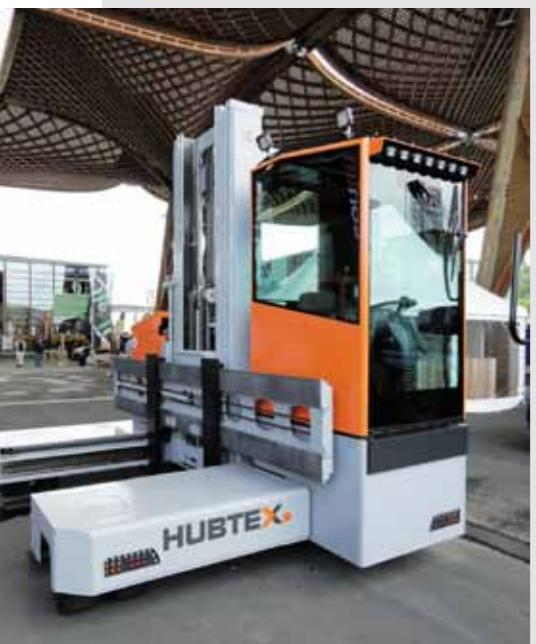
многоходового аккумуляторного погрузчика в мире в своем классе. Этот погрузчик благодаря конструктивным особенностям – проверенному годами мультифункциональному джойстiku с интегрированной системой смены направления движения, эргономичной кабине, модульной системе рамы шасси и использованию AC-технологии переменного тока (80В) – является настоящим «законодателем мод».
