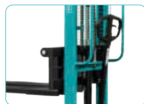
Ограничитель для защиты рук оператора при резком опускании рукоятки
