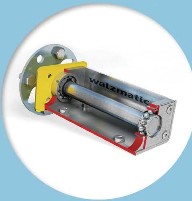
Узел разработан в компании Walzmatic, состоит из корпуса, подшипников и ступицы, как у автомобиля. Эта конструкция позволяет выдерживать до 300 кг нагрузки на каждое колесо. Обеспечивает высокую надёжность и большую грузоподъёмность тележки. При необходимости легко монтируется и обслуживается.
