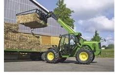
предыдущей модели, и вращающий момент 360 фунтов на фут (увеличен на 17%). Насосы переменного объема и гидравлическая система с замкнутым контуром, заменившая гидросистему с открытым контуром, увеличили подачу масла на 20%. Как утверждают специалисты John Deere, продолжительность рабочего цикла новинок в среднем увеличилась на 35%.
