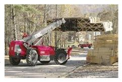
Стрела телескопического погрузчика медленно перемещает вилы в горизонтальном направлении, поэтому операторы не любят таким движением извлекать вилы из-под установленных на высокой площадке поддонов. Однако подавать машину назад с поднятой стрелой опасно, особенно на строительной площадке, где велика вероятность того, что колесо неожиданно провалится. Скорее всего, стрела при этом покачнется, и машина опрокинется.
