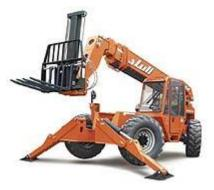
Особенности производственной программы изделий. Lull подобно SkyTrak линии JLG предлагает StabiliTrak – систему с тремя режимами стабилизации задней оси. При необходимости система StabiliTrak автоматически переводит машину из неустойчивого положения с тремя опорными точками в положение с четырьмя точками опоры.
