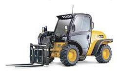
Телескопические погрузчики, предназначенные для манипуляций с грузовыми вилами в качестве основного оборудования, оснащают гидравлическим цилиндром, выдвигающим вторую секцию стрелы, а цепи или тросы, связанные с этой секцией, синхронно с ней выдвигают третью и четвертую секции. Секции стрелы не фиксируются стопором. В их конструкции предусмотрены противоизносные накладки, которые легко заменить: благодаря такой конструкции увеличивается ресурс стрелы.
