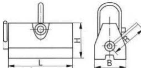
Рисунок 2. Габаритные размеры магнитного захвата.
