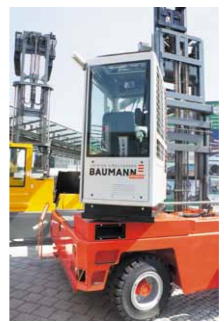
Уникальная опция на боковом дизельном погрузчике Ваумп — поворотная кабина
