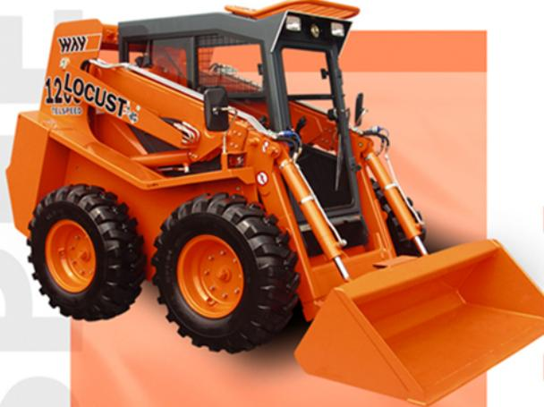
Минипогрузчик Locust L1203TELSPEED с номинальной грузоподъемностью 1200 кг оснащен телескопической стрелой с высотой подъема до 4070 мм и двухскоростными гидромоторами.
