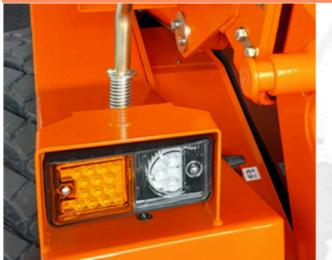
В базовую комплектацию всех минипогрузчиков Locust входит оснащение всем необходимым для перемещения по дорогам общего пользования: сигналы поворота, стоп-сигналы, проблесковый маячок, пластина для номерного знака с подсветкой
