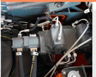
Тандемные аксиально-поршневые насосы REXROTH, обладая высоким КПД, обеспечивают непревзойденную производительность гидравлической системы, также обеспечивая устойчивый гидропоток в 78 л/мин. у машин L753 и L903, и в 110 л/мин. у машин L1203 и L1203TELSPEED
