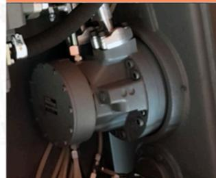
Применение в конструкции мини-погрузчика мощных гидравлических радиально-поршневых моторов REXROTH MCR 5 обусловлено достижением эффекта пониженного нагревания гидравлического масла, что значительно расширяет предельное время непрерывной работы в режиме максимальной нагрузки.
