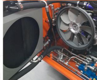
Радиатор охлаждения двигателя откидывается в сторону, открывая превосходный сервисный доступ для обслуживания двигателя. Кабина минипогрузчиков Locust максимально откидывается вперед, обеспечивая максимальную доступность к узлам и компонентам.
