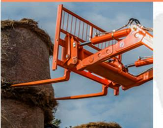
Автоматическая система самовыравнивания оборудования на подъем входит в базовую комплектацию машин, позволяя более аккуратно выполнять погрузочные работы
