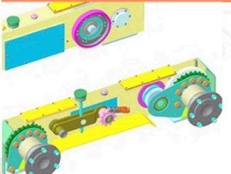
Использование в конструкции дополнительной шестерни обеспечивает увеличенный крутящий момент, а вынесение редукторов за пределы гидромоторов увеличивает ресурс последних. Техническое обслуживание заключается в подтягивании цепи и замене трансмиссионного масла.
