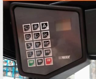
Минипогрузчики Locust максимально технологичны, удобная панель с контактными кнопками и ЖК дисплеем позволяет в режиме реального времени контролировать все функции минипогрузчика. Кнопочный замок зажигания позволяет осуществлять бесключевой запуск двигателя.
