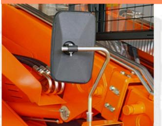
Зеркала бокового обзора закреплены на раме погрузчика, а не на стреле, как это бывает у некоторых минипогрузчиков других производителей, что позволяет сохранить прекрасную обзорность рабочей зоны во время движения погрузчика Locust даже при поднятой стреле.
