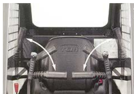
Рабочее место оборудовано штангами безопасности
