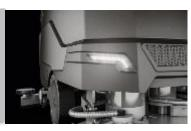
За счет отсутствия опорных роликов машину можно эффективно использовать для размывания поверхности стоя на месте, нет необходимости ходить по кругу
