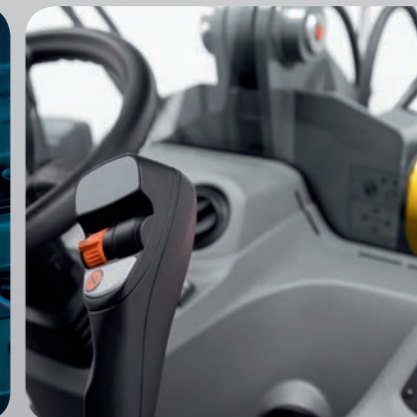
Чувствительное и точное управление машиной и навесным оборудованием посредством джойстика с механическим управлением.
