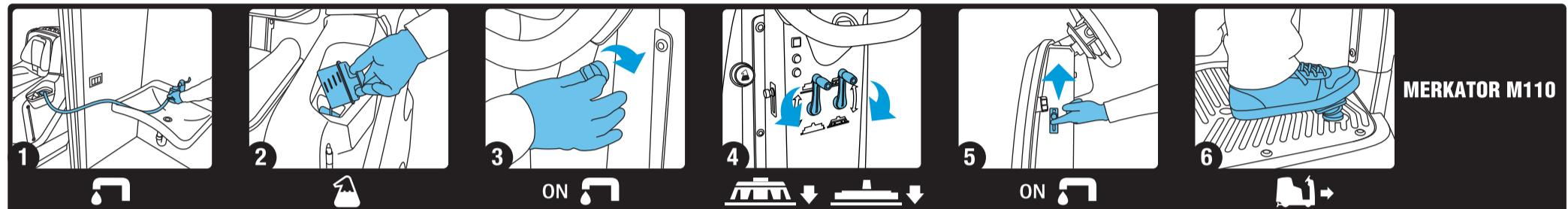
RU Залейте водопроводную воду в бак раствора при помощи встроенного шланга
