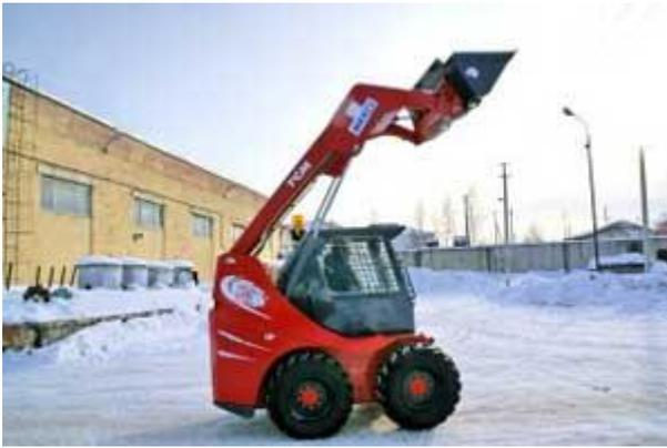
Силовой агрегат погрузчика - дизель объемом 3,3 литра мощностью 65 л.с. Максимальный крутящий момент в 210 Нм он развивает уже при 1 800 об/мин. Примечательной особенностью данного двигателя является невысокий уровень шума.
