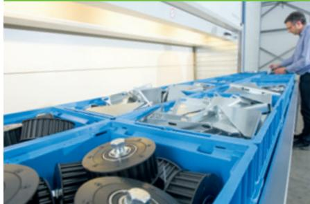
Неповторимая выносливость: Полка для тяжелых грузов выдерживает 800 кг груза при рабочей ширине 4.050 мм. Она идеально подходит для средних и тяжелых грузов и ставит рекорд грузоподъемности.
