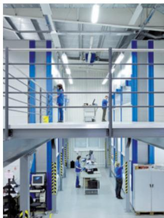
Вертикальные подъемные модули могут охватывать несколько этажей и оснащаться максимум шестью окнами раздачи в любом месте передней или тыльной стороны устройства. Промежуточные этажи позволяют при этом работать одновременно на нескольких уровнях, например, с одной стороны принимать товары на склад, а с другой – выдавать товары.
