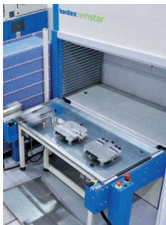
Полное выдвижение полок облегчает работу с тяжелыми и крупными товарами, требующими участия подъемных механизмов. Выдвинутая полка ставится перед окном раздачи для поруки и выгрузки. После этого обработка выполняется просто и безопасно на транспортной тележке.
