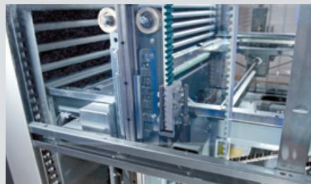
Экстрактор транспортирует нужную полку после нажатия кнопки или считывания штрих-кода с высокой скоростью перемещения либо непосредственно к окну раздачи, либо на свободное место для хранения в устройстве.
