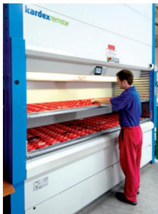
При помощи опции «двойной отбор» в окне раздачи можно выполнять операции на двух уровнях: одна несущая полка подается в окно раздачи на первом рабочем уровне, после этого подъемная дверь закрывается. Пока оператор заполняет полку или берет с нее детали, следующая несущая полка подается за окном раздачи.
