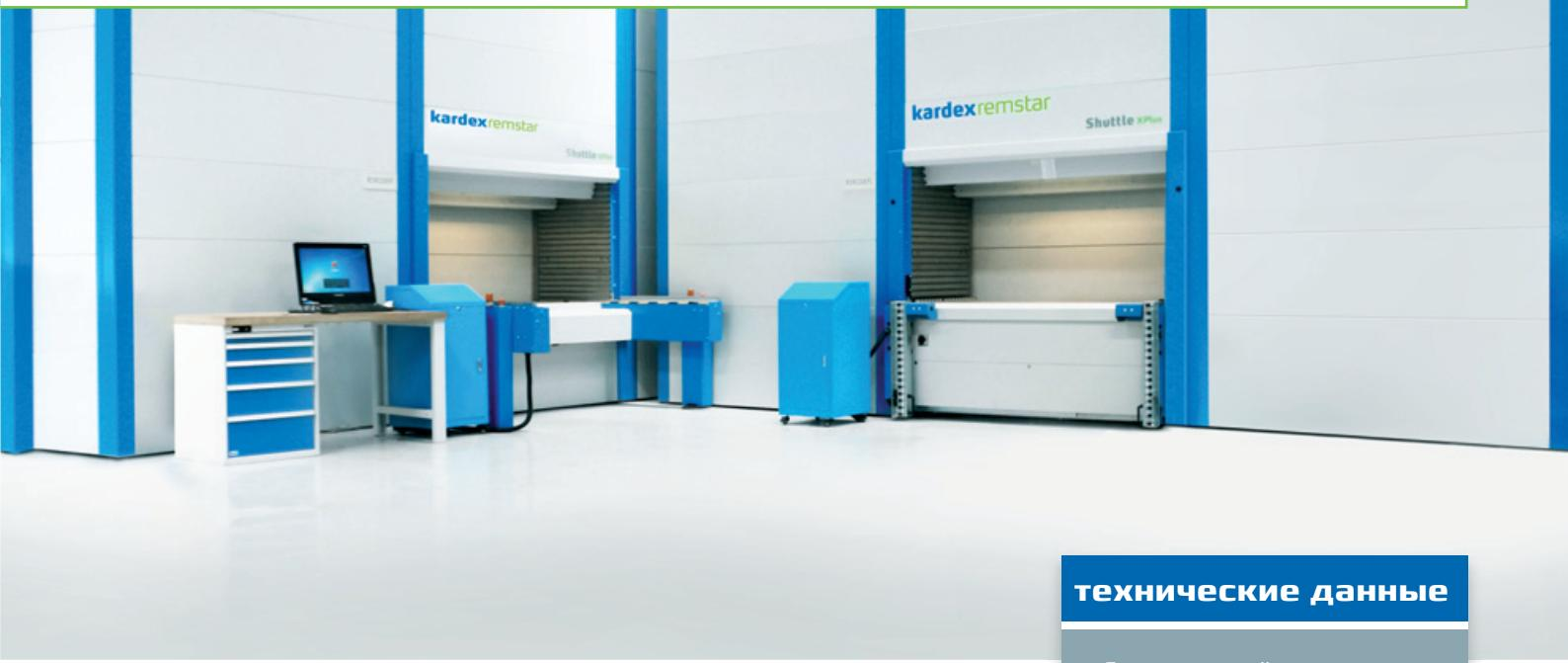
Shuttle XPlus – идеальный склад большой вместимости: до 2.300 кв. м. складской площади и до 240 тонн загрузки на основании всего 20 кв. м. Подъемная балка объединяет несколько подъемных модулей в Shuttle XPlus. Экстрактор на подъемной балке доставляет полку с товарами либо в окно раздачи, либо на свободное место для хранения в одном из соединенных модулей. Экстрактор движется через подъемные модули кратчайшим путем: по диагонали.
