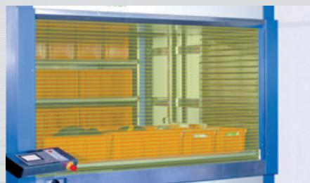
При срабатывании защитного фоторелейного барьера, расположенного непосредственно перед окном раздачи, все перемещения на устройстве сразу же останавливаются.
