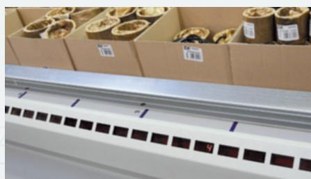
Для повышения производительности, пропускной способности и точности Kardex Remstar предлагает встроенные решения Pick-to-Light для Shuttle XP: индикаторы положения, световые сигналы и панели подтверждения в окне раздачи.
