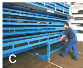
Die Steuerung setzt die Kassette zur Entnahme ab.
